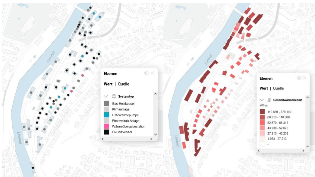
Abbildung 6-1: Aktuell installierte Heizsysteme (links) und jährliche Gesamtwärmebedarf der Gebäude in kWh/a (rechts) im Versorgungsgebiet V1 gemäss Urbio. Bei den Heizsystemen sind die Klimaanlage und PVA ausgeblendet, weil sie für die Wärmeerzeugung nicht relevant sind.
